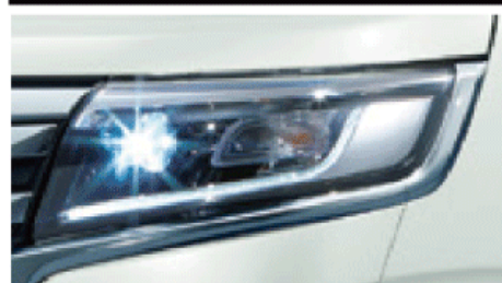
LEDヘッドランプ [ハイ/ロービーム、オートレベリング機構付]
