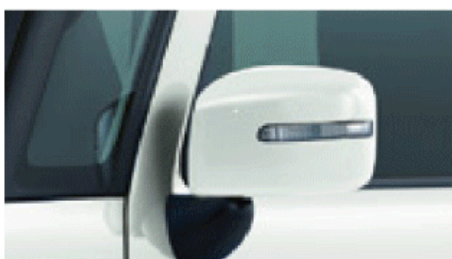
電動格納式リモコンドアミラー [リモート格納]
